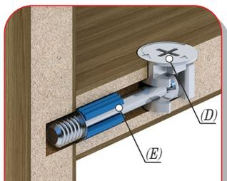
1. В отверстие диаметром 5 мм на поверхности боковины вкручивается шток (E).
