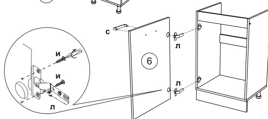
6. Для установки ручки (з) на фасад необходимо досверлить глухие отверстия диаметром 5 мм насквозь. Далее закрепить ручку саморезом (с) и навесить фасад.
