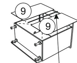
Схема крепления соединительного элемента
