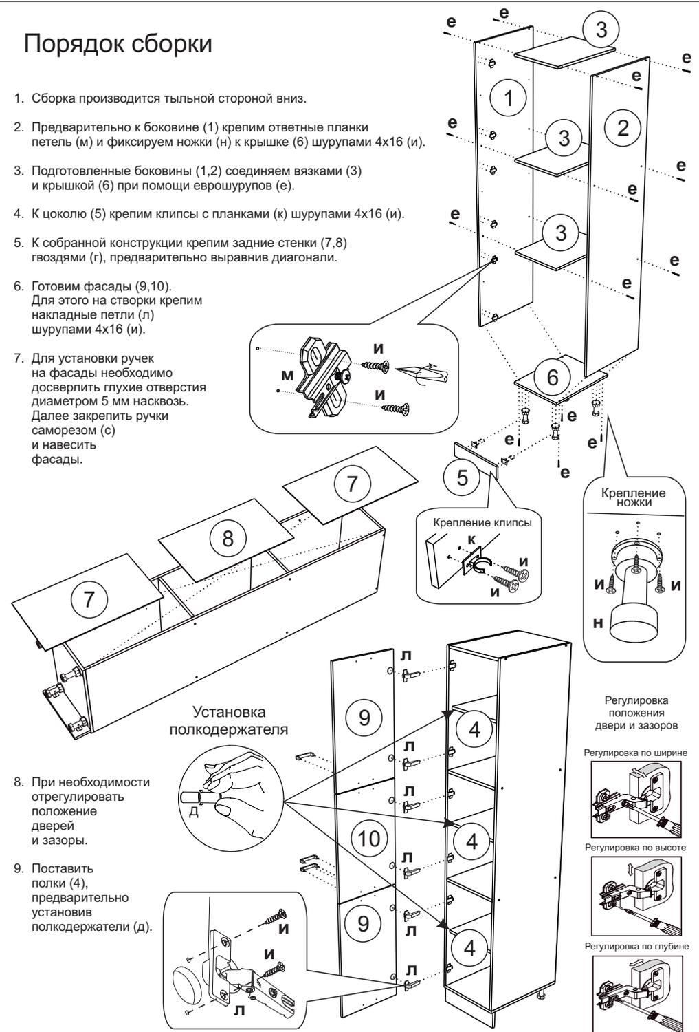
Регулировка положения двери и зазоров
