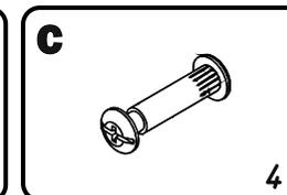
СОЕДИНИТЕ СЕКЦИИ МЕЖДУ СОБОЙ С ПОМОЩЬЮ МЕЖСЕКЦИОННЫХ СТЯЖЕК ЧЕРЕЗ ОТВЕРСТИЯ В ПЛАНКЕ И БОКОВИНЕ
