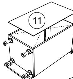
6. К собранной конструкции крепим заднюю стенку (11) гвоздями (г), предварительно выравнив диагонали.
