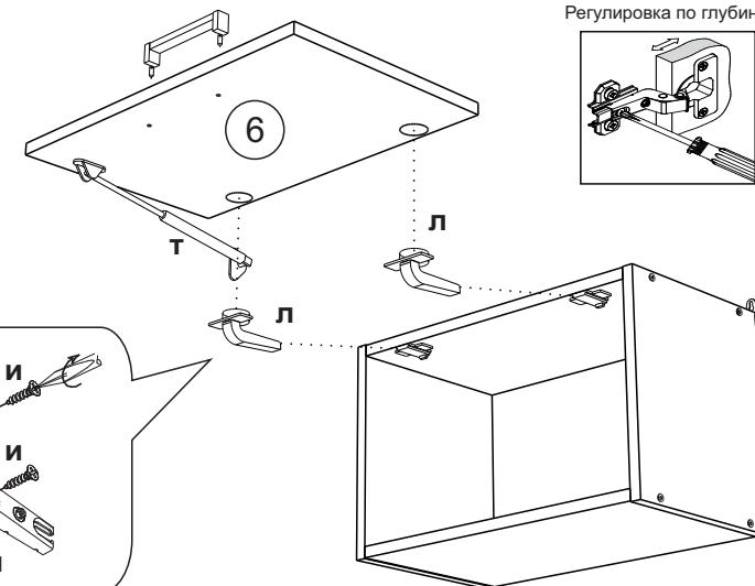
Схема крепления соед.элемента
