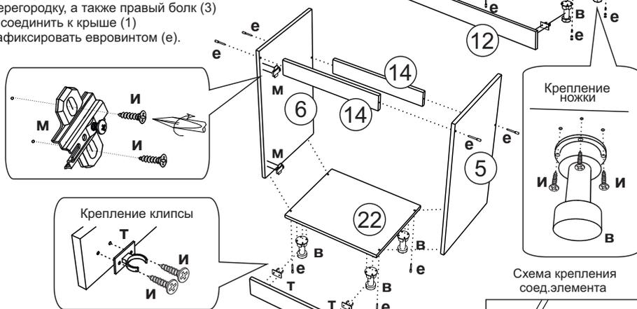
4. Производим сборку корпуса мойки 500 мм. Боковины (5 и 6) соединяем планками (14) и крепим к крышке (22). Крепление осуществляем при помощи еврошурупа (е).
