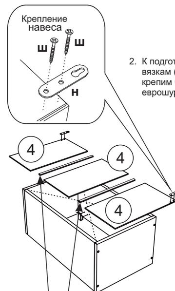
4. После чего к верхней части конструкции крепим навесы (н) шурупами 4x25 (ш).
