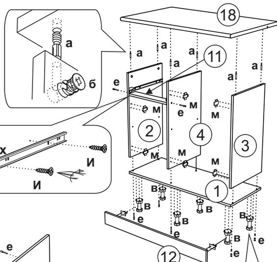
2. На крышку (18) установить штоки эксцентриковой стяжки (а).
