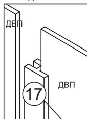
5. В секцию 1000 мм укладываем ДВП (30) в больший проем секции, используя соединительный брус в месте стыка, а ДВП (26) в меньший проем. Закрепляем ДВП гвоздями (г). В месте крепления ДВП (26и30) к перегородке (20) дополнительно использовать пластмассовую шайбу (у). В секцию 500 мм уложить ДВП (27) и закрепить гвоздями.
