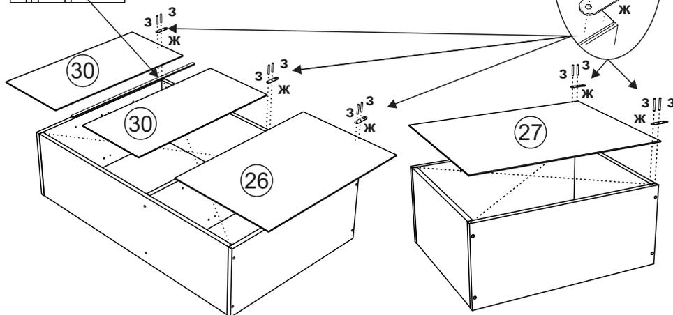
7. Расположив секции по местам, необходимо установить полкодержатели (д). Обращаем ваше внимание на то, что секция 500 мм предусмотрена как сушка и не имеет полки. Также в секции 1000 мм при необходимости возможно вынуть полки и установить сушку дополнительно. Далее вложить полки (7 и 21).
