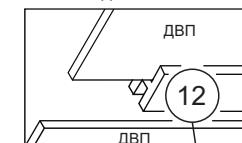
7. Заднюю стенку (11) крепим гвоздями (г), предварительно выравнив диагонали и установив соединительный брус (12).
