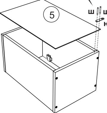
4. После чего к верхней части конструкции крепим навесы (н) шурупами 4x25 (ш).
