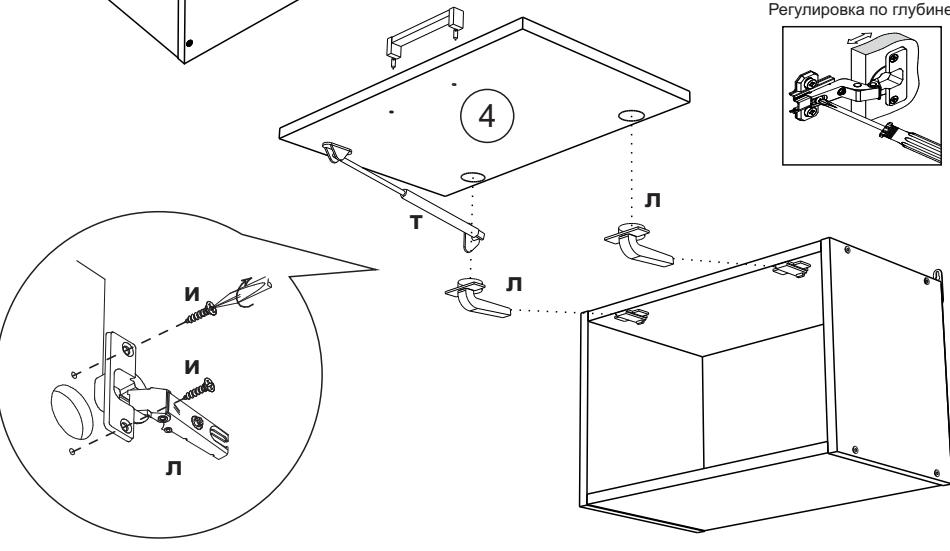
Регулировка положения двери и зазоров
