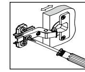
Регулировка по глубине
