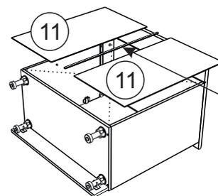
Схема крепления соединительного элемента
