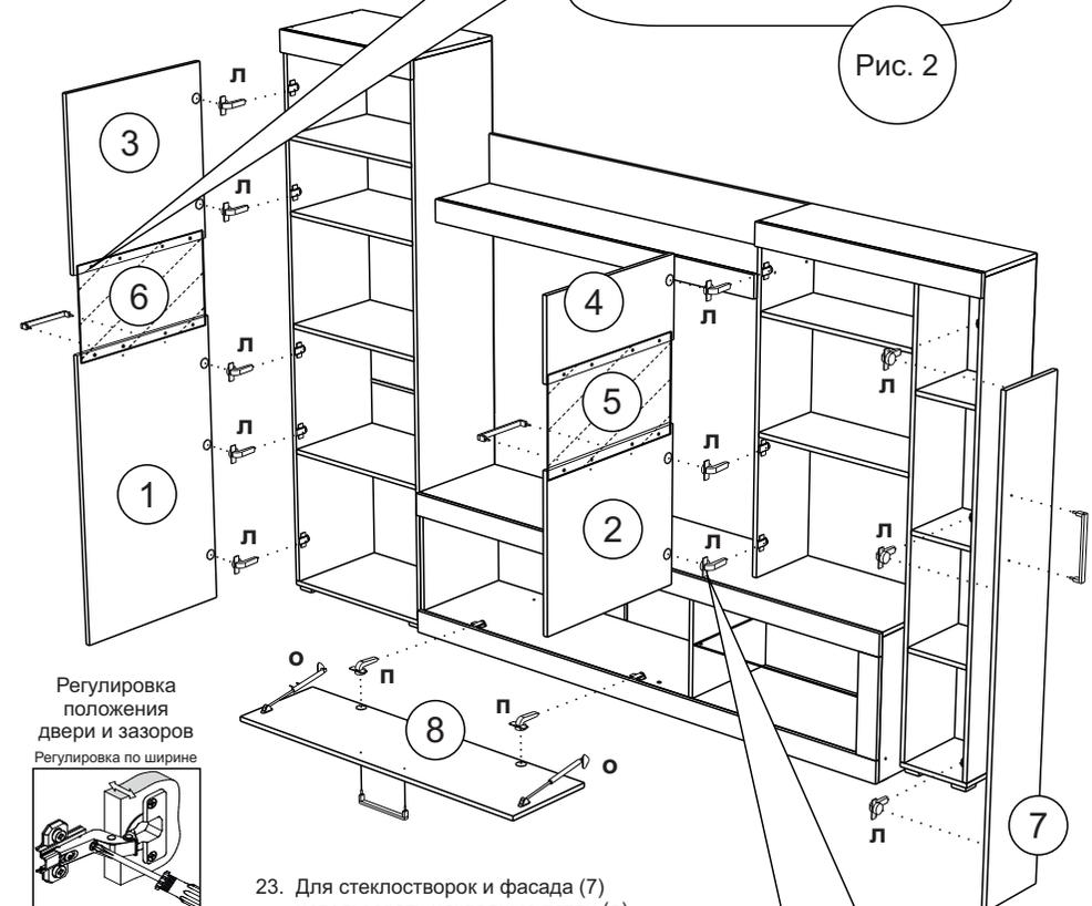
Регулировка положения двери и зазоров
