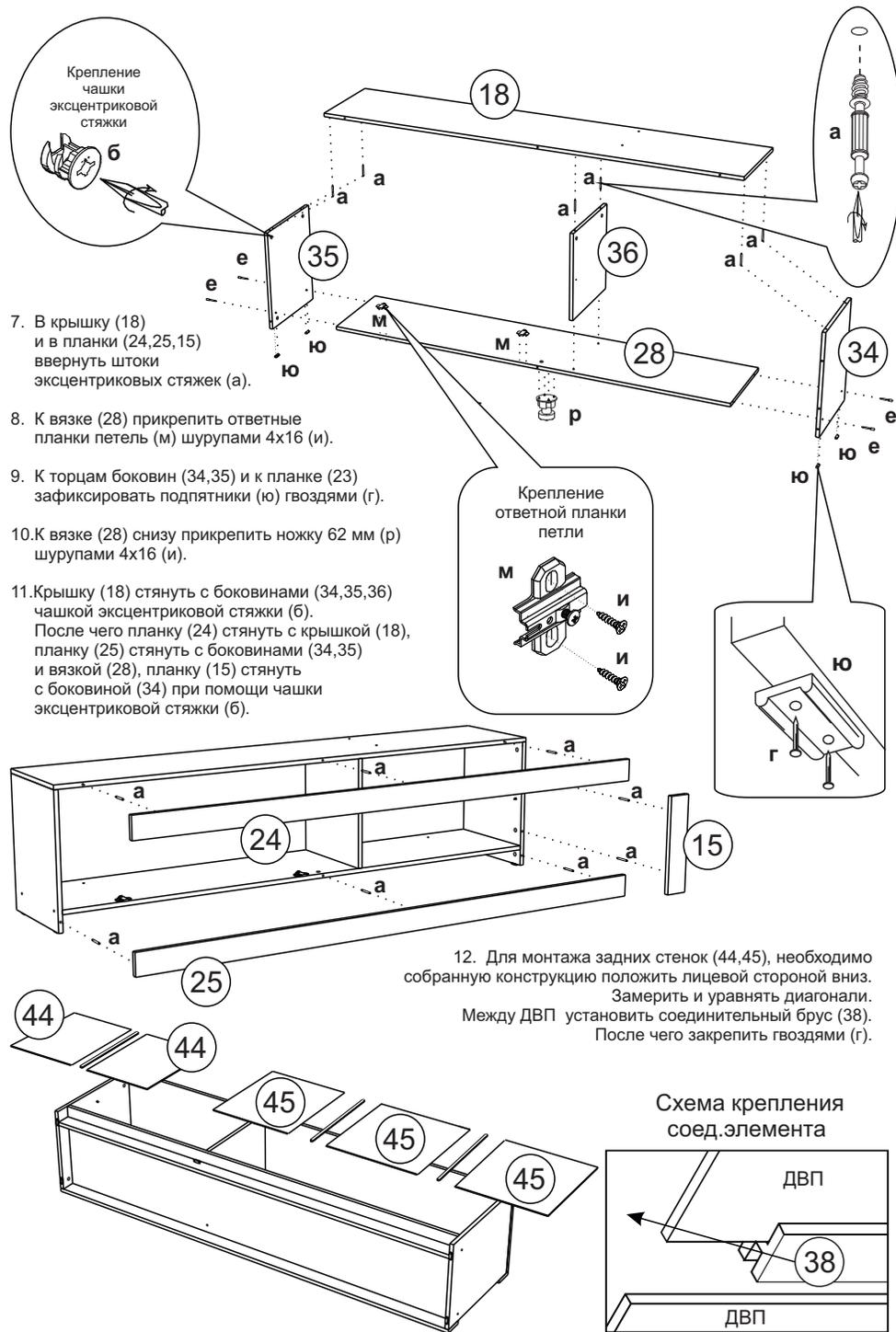
7. В крышку (18) и в планку (24, 25, 15) ввернуть штоки эксцентриковых стяжек (а).
