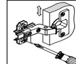
Регулировка по глубине
