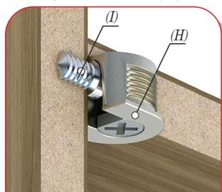
1. В отверстие диаметром 5 мм на поверхности боковины вкручивается дюбель (I).
