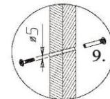
Для соединения 2-х и более секций используйте стяжные винты (поз. 9). Для этого выровняйте секции и просверлите отверстия Ø5 мм.
