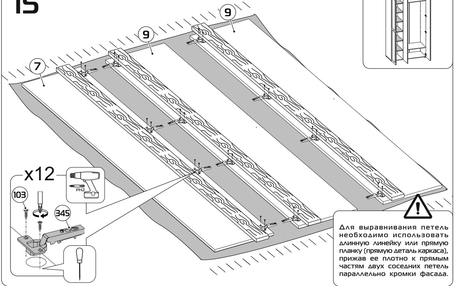
Для выравнивания петель необходимо использовать длинную линейку или прямую планку (прямую деталь каркаса), прижав ее плотно к прямым частям двух соседних петель параллельно кромки фасада.
