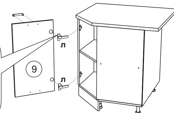
Регулировка положения двери и зазоров
