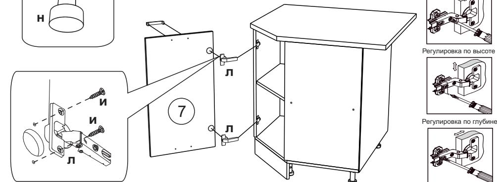
Регулировка положения двери и зазоров
