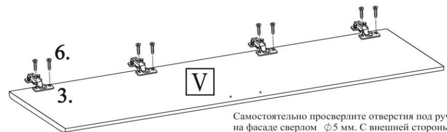
Самостоятельно просверлите отверстия под ручку на фасаде сверлом  $\phi 5$  мм. С внешней стороны прикладывайте брускок во время сверловки.
