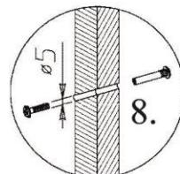
Для соединения 2-х и более секций используйте стяжные винты (поз. 8). Для этого выровняйте секции и просверлите отверстия  $\phi 5$  мм.
