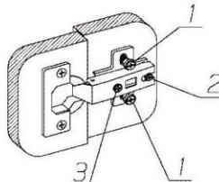
1. Винт крепления и регулировки двери по высоте (вверх-вниз).
